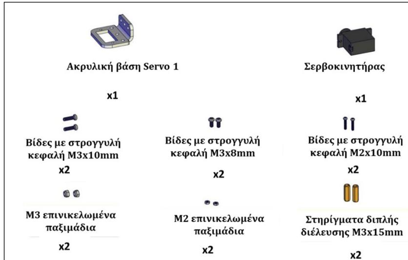
Βιδώστε την ακρυλική βάση του σερβοκινητήρα πάνω στο βραχίονα χρησιμοποιώντας τις 2 βίδες στρογγυλής κεφαλής M3x10mm και τα 2 M3 επινικελωμένα παξιμάδια. Έπειτα, στερεώστε τον σερβοκινητήρα πάνω στην ακρυλική βάση χρησιμοποιώντας τις 2 βίδες στρογγυλής κεφαλής M2x10mm και τα 2 M2 επινικελωμένα παξιμάδια. Τέλος, στερεώστε τα δύο στηρίγματα διπλής διέλευσης κάτω από την ακρυλική βάση χρησιμοποιώντας τις 2 βίδες στρογγυλής κεφαλής M3x15mm.
